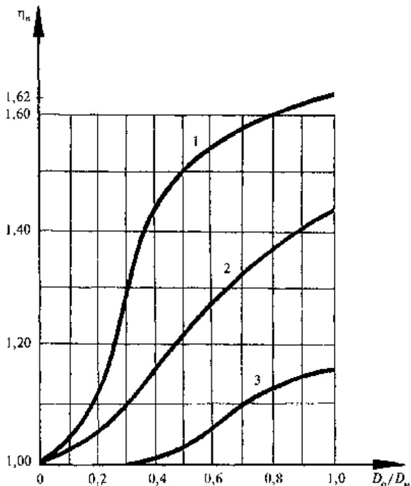
1 — для сварных без усиливающих накладок; 2 — для штампованных и штампосварных;
